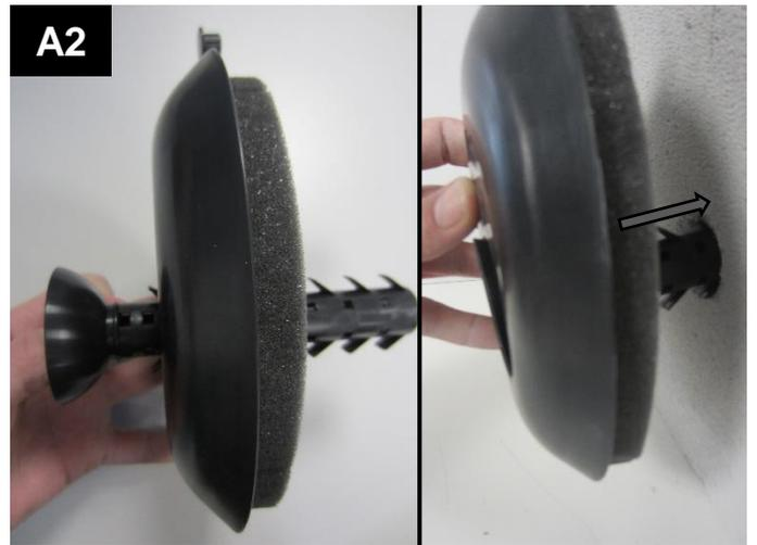
Bauen Sie den Dübel und den Flansch zusammen. Richten Sie den Flansch so aus, dass die Einspritzöffnung oben ist, Pfeile zeigen nach oben. Drücken Sie das System in die Bohrung, bis der Flansch an der Wand anliegt.
